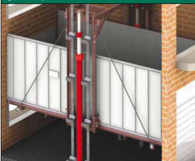
Figura 2 - Piattaforma di cabina Figure 2 - Car platform
